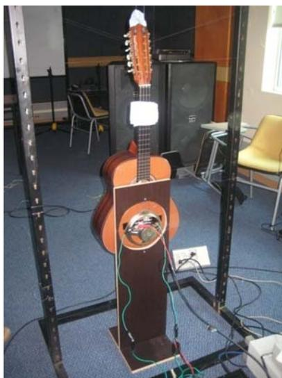
**Figura 2.** Montaje experimental del transductor al instrumento.
