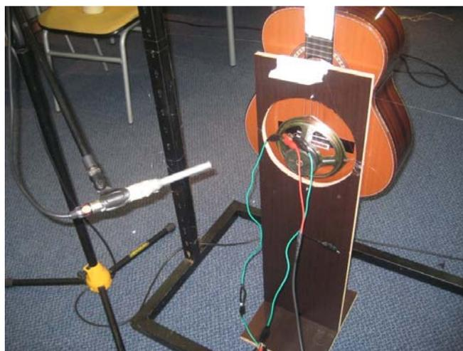
**Figura 3.** Montaje experimental para capturar respuesta al impulso.
