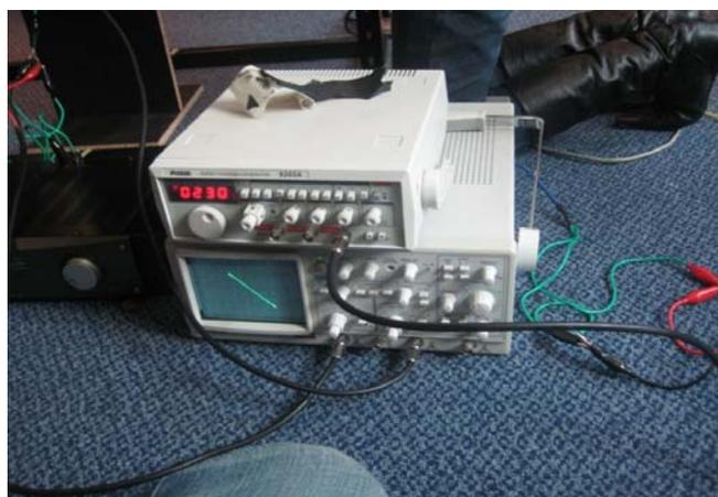
**Figura 4.** Montaje experimental para medición según Thielle-Small.
